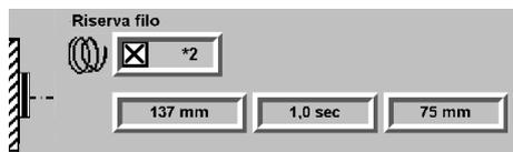
Se la funzione **Guidafilo destra** non è attiva (vedere **Configurazione - Dotazione**), compare anche il parametro 2<sup>a</sup> Riserva filo. Con il tasto \*2 viene avvolta una seconda riserva filo con almeno 4 avvolgimenti.
