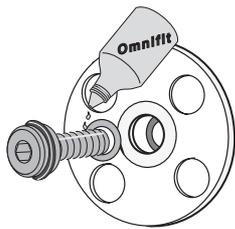
Fig. 8-8 Fissaggio del rullo di rinvio
