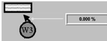
La tensione del filo dipende dalla differenza di velocità tra il rullo stabilizzatore W3 e l'avvolgitore. La tensione del filo risultante determina la durezza della rocca.
