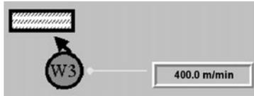
La velocità del rullo stabilizzatore W3 dipende dalla velocità dell'alimentatore W2. Quindi, in caso di modifiche a W2, la velocità del rullo di stabilizzazione W3 viene automaticamente adattata.
