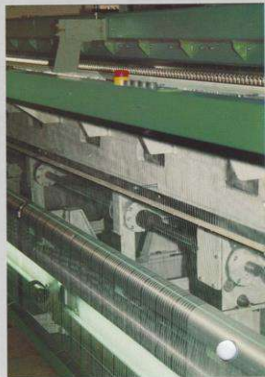
Nähfadenzuführung über Lieferwerk mit Blick auf 2. Hauptwelle.
