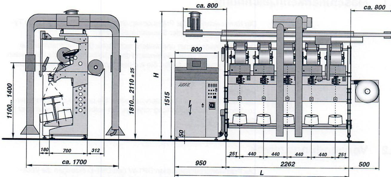
Abb. 2-1 Schaltschrank mit einer Sektion und Optionen Staubschutzgebläse und Wanderbläser (Abmessungen in mm)
